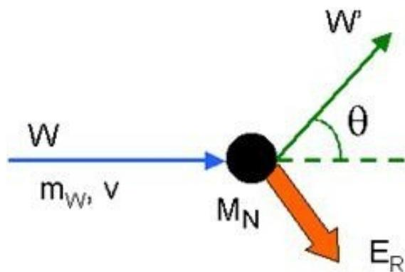
Рис. 12: Прицип детектирования вимпов. Где  $m_W$ ,  $V$  — масса и скорость вимпа,  $M_N$  — масса ядра,  $E_R$  —энергия отдачи, которая впоследствии и детектируется. [24]
