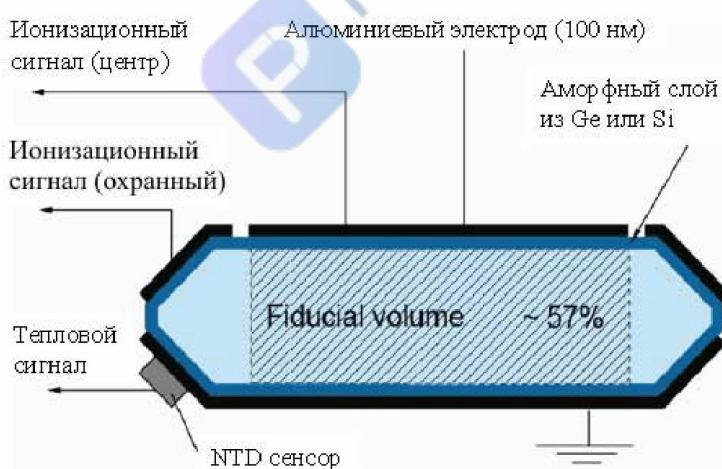
Рис. 14: Принципиальная схема NTD германиевого болометра, используемого в эксперименте EDELWEISS. [12]
