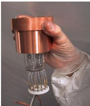
Рис. 20: Внешний вид низкофонового ФЭУ использующийся в DAMA / LIBRA. [32]
