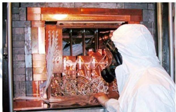
Рис. 21: Установка детекторов внутрь куба. [32]
