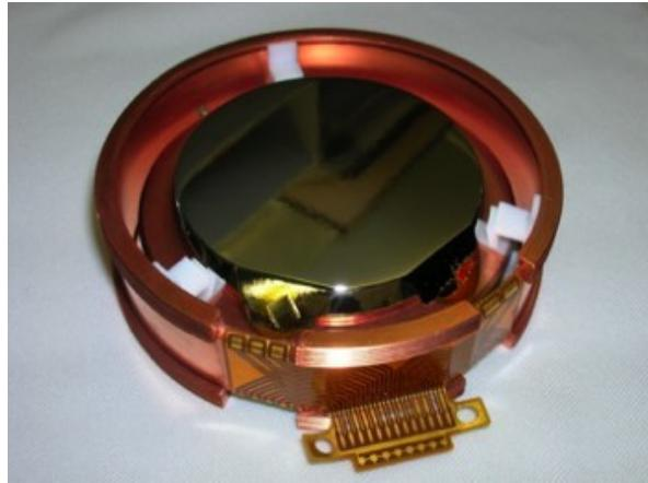
Рис. 15: Внешний вид NTD германиевого детектора, используемого в эксперименте EDELWEISS. По бокам можно заметить электроды и сверхчувствительный прямоугольный термометр, наклеенный на кристалл. [24]
